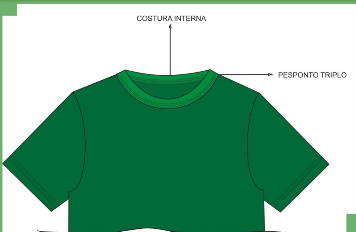
Figura 46 – Peça acabada: friso 1 vira, pesponto triplo
