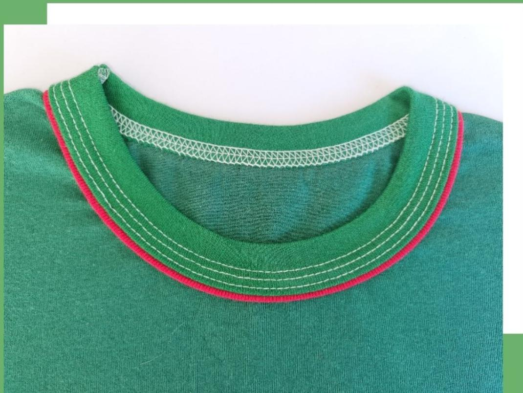
Figura 31 – Friso com filete 1 vira, pesponto triplo com trançador superior (1ª, 2ª e 3ª Ag. + Looper/Trançador superior)
