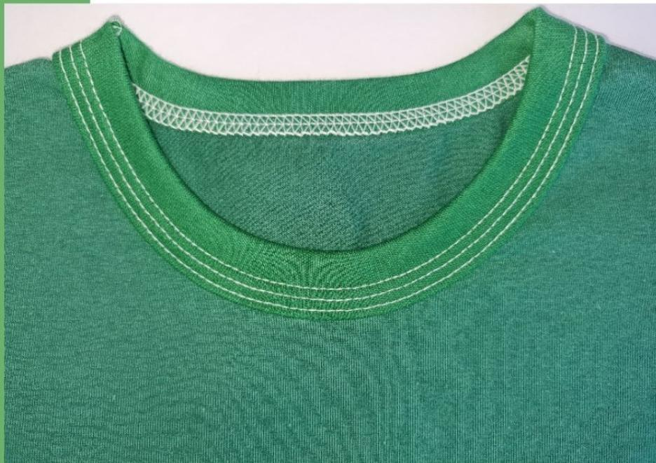
Figura 47 – Friso 1 vira, pesponto triplo com trançador superior (1ª, 2ª e 3ª Ag. + Looper/Trançador superior)
