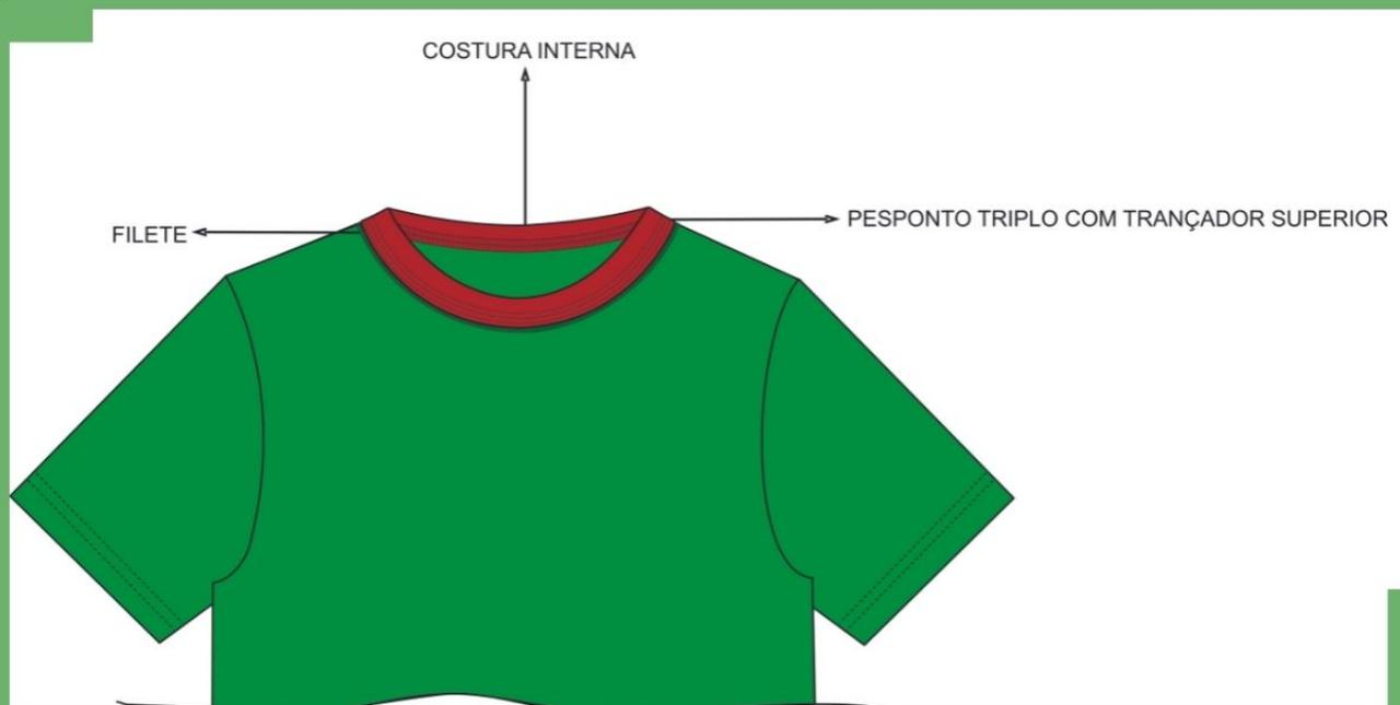
Figura 34 – Peça acabada: friso com filete 1 vira, pesponto 3 Agulhas com trançador superior
